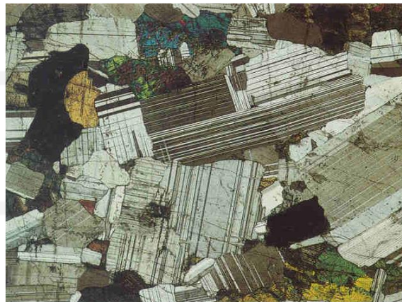
Figura 1 – Amostra de gabro em lâmina delgada com cristais prismáticos subédricos de plagioclásio (cor cinza) com piroxênio intersticial (cor esverdeado) e magnetita (cor preta) apresentando textura granular. Aumento 20x (Extraído de Mackenzie et al. , 1982)
