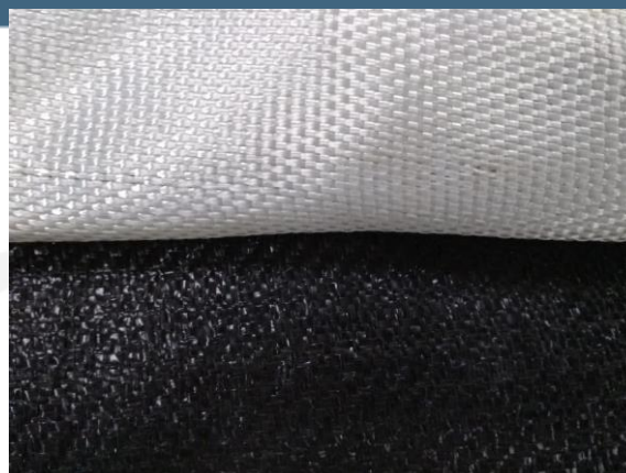
FIGURA 2. Geotêxteis de PP (preto) e PET/PA (branco)
