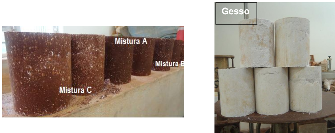
Figura 2: Amostras após a compactação.
