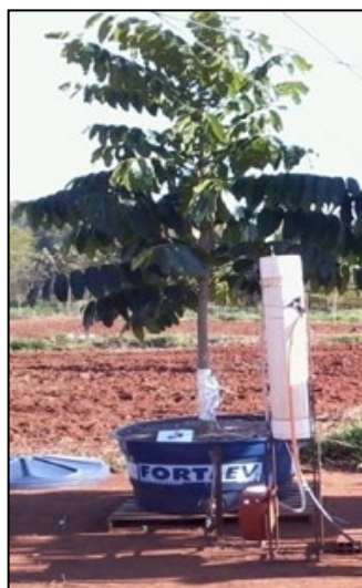
Figura 1. Lisímetro de lençol freático constante.
