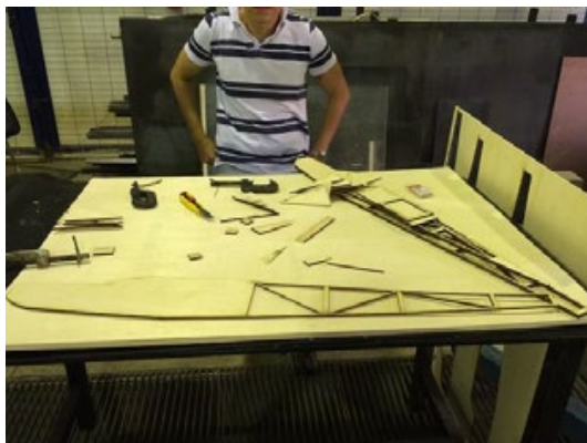
Figura 4: Peças prontas da fuselagem. Fonte: Autor
